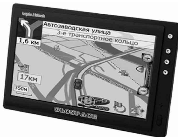
Рис. 3.32. Экран прибора-навигатора GloSPACE с отображением плана московских улиц в перспективной проекции и указанием местоположения наблюдателя
